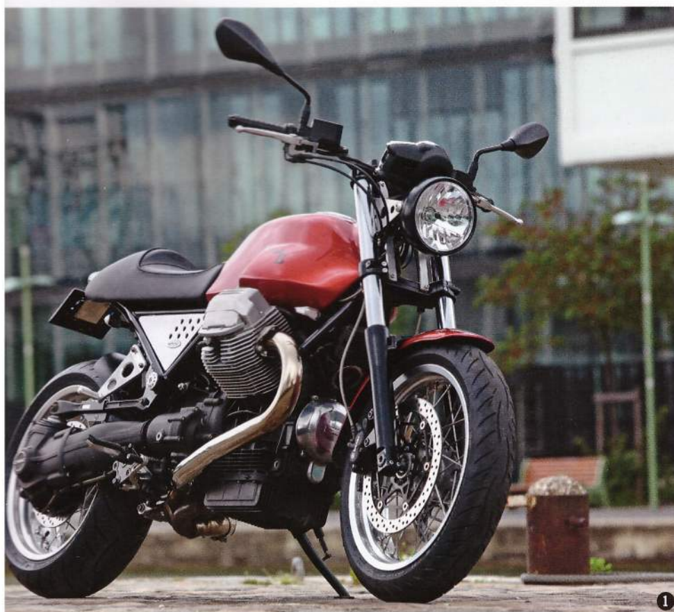
① On aperçoit ici les deux montants, fixés au té inférieur, qui viennent soutenir le phare. ② Le moteur de la Bellagio méritait depuis longtemps d'être exploitée sur une moto plus «roadster».
