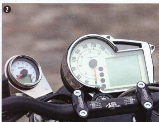
❶ Cette version Gulf de la MB9 a été montée avec le petit phare (14 cm). ❷ Le compte-tours additionnel Koso indique aussi la température moteur. ❸ Les petits clignos en embouts de guidon sont assez visibles.
